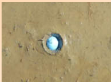
写真1 ゴルフボールで硬さを確認
