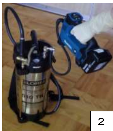
塗布器に石灰乳を入れて 電気式空気入れで加圧する
