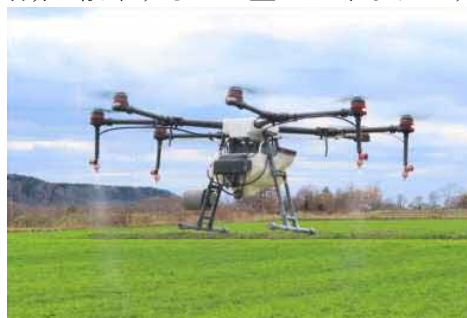
写真6-2 ドローン散布の様子
