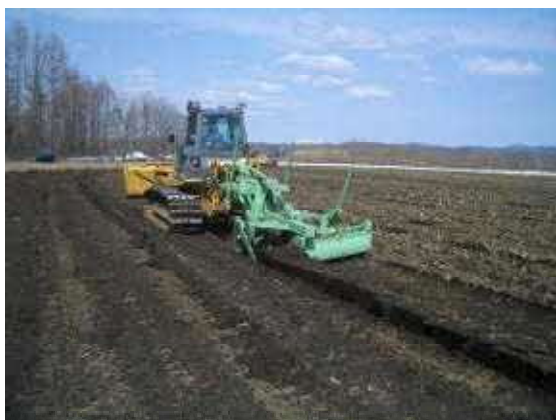
写真1-18, 19 カuttingソイラ(公社事業)による作業(左)と根域層の拡大(右)
